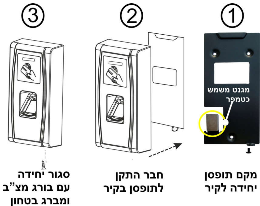
איור 8: התקנת היחידה לקיר
