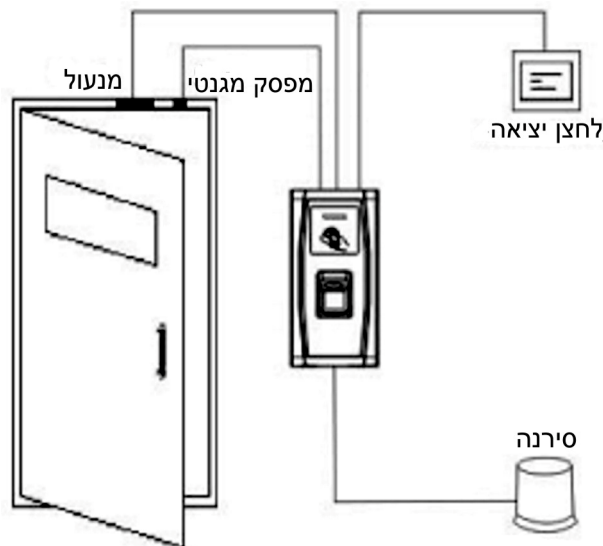
איור 2 : התקנה לדוגמא של הקורא עם חבור אביזרים נלווים לבקרת כניסה
